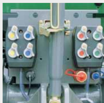
DUDK-Kupplungen; Externer Load-Sensing-Hydraulikanschluss
