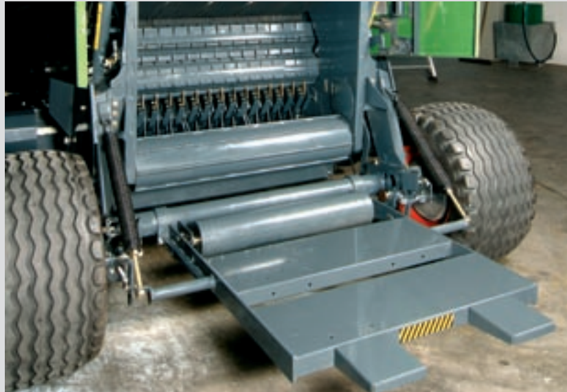
Die Kombination von Walzen im Frontbereich und Riemen im Heckbereich sorgt für eine hohe Pressdichte und ermöglicht eine Ballendichte nach Wahl.
