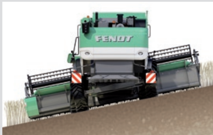
Auto-Level-Hangausgleich für volle Leistung bis 20 Prozent Hangneigung
