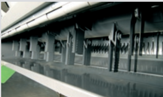
8-Stern-Häcksler mit gezahnten Messern für beste Häckslerqualität
