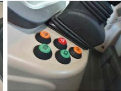
Der Fahrmodus ist individuell wählbar: Die Geschwindigkeit regelt entweder das Fahrpedal oder der Variostick.
