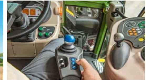
Der elektrische Kreuzschalthebel steuert den Frontlader äußerst feinfühlig. Der 3. und 4. Steuerkreis wird ohne Umgreifen über Druckknöpfe am Kreuzschalthebel bedient.
