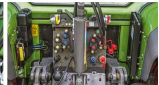
Im Heckanbaubaum sind alle Anschlüsse dauerhaft gekennzeichnet und aufgeräumt angeordnet. Die selbstschließenden Ventilkappen verhindern Schmutzeintrag.
