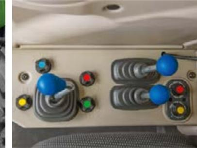
Komfortable elektrohydraulische Heckkraftheber Bedienung mit aktiver Schwingungstilgung.
