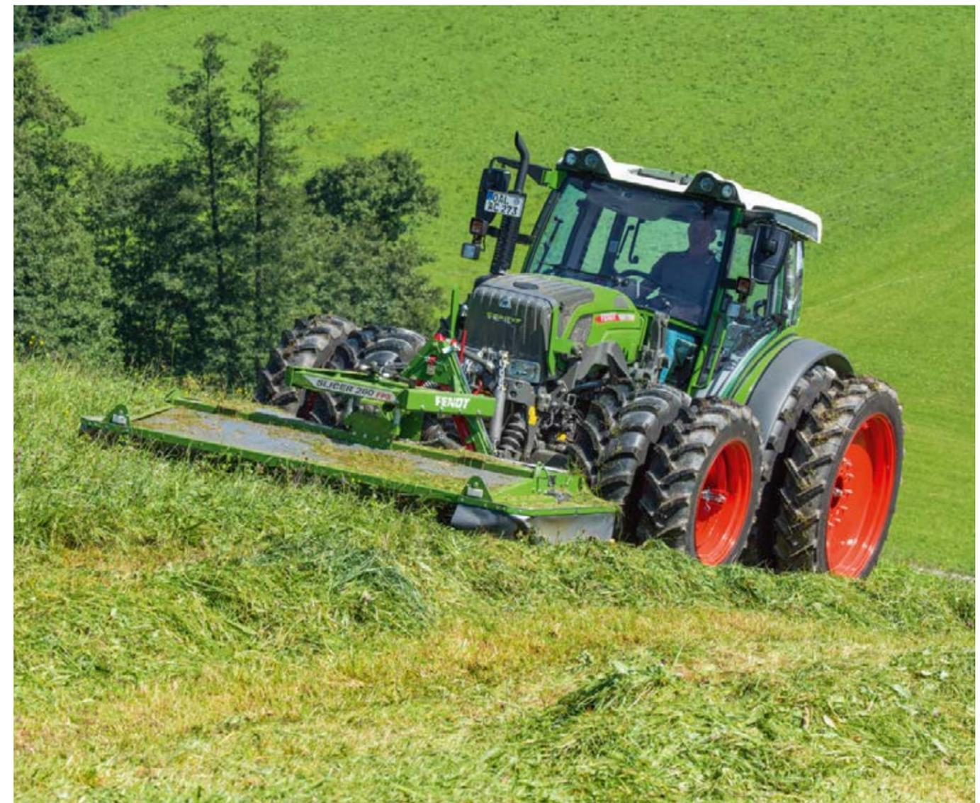
Sicher und verschleißfrei anhalten und wieder losfahren, auch am Berg mit großer Last: Dank der aktiven Stillstandsregelung der Fendt Variogetriebe gelingt das vollkommen ruckfrei.
