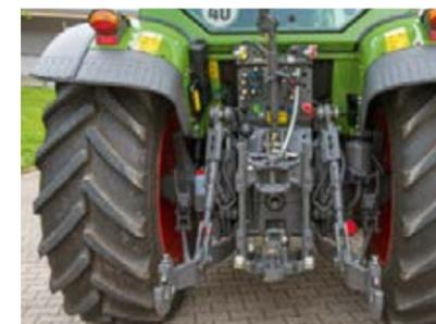
2-Leiter Druckluftbremse, vier Hydraulikventile und Power-Beyond. Trotz der Kompaktheit erreichen Sie alle Anschlüsse sicher und bequem.
