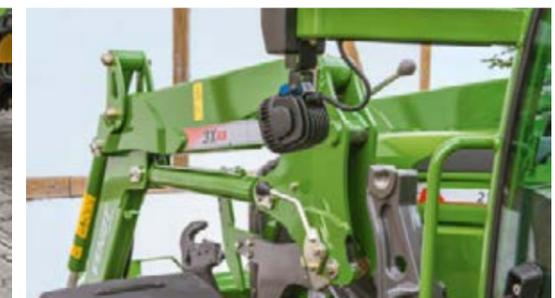
Mit Fendt Cargo-Lock klappt der An- oder Abbau in Minutenschnelle. Die Stützen lassen sich werkzeuglos entriegeln. Der Cargo steht immer fest und sicher.
