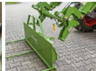
Ein Hebel am Schnellwechselrahmen entriegelt das Werkzeug bequem mit einem Handgriff. Beim Anbau verriegelt das Werkzeug beim vollständigen Einkippen automatisch.
