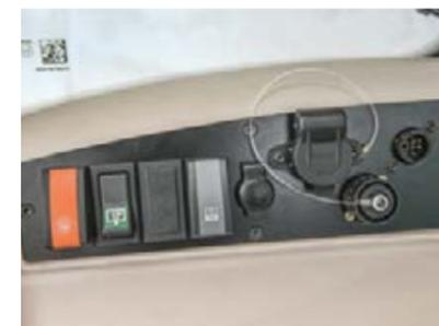
Im Fendt 200 Vario ist alles zentral zusammen gefasst wie z.B. die Stromversorgung und Signalsteckdose für externe Geräte.
