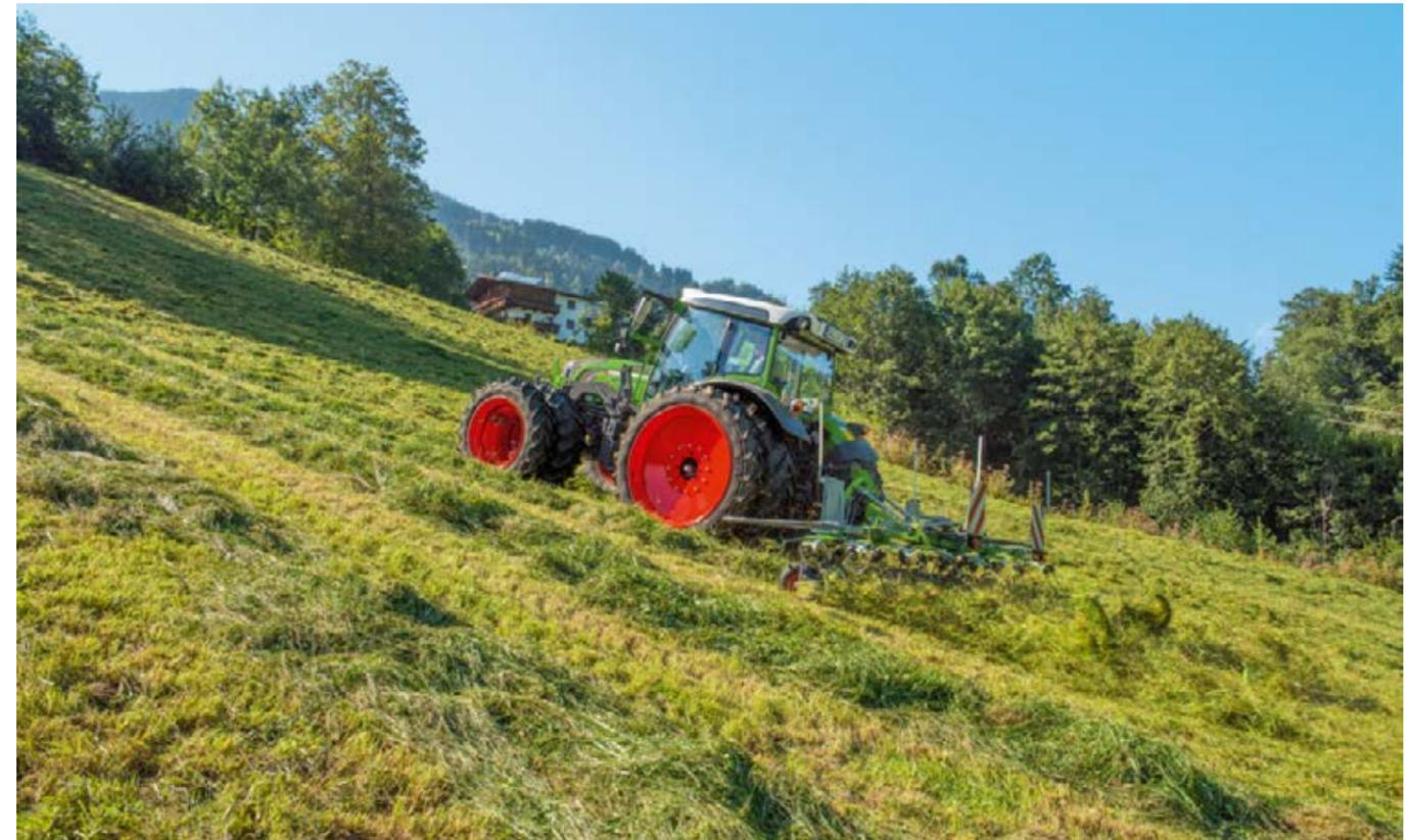
Mit der VarioActive Überlagerungslenkung erreichen Sie den vollen Lenkeinschlag mit nur einer Lenkradumdrehung, was sich bei Frontlader- und Hofarbeiten und am Vorgewende auszahlt.
