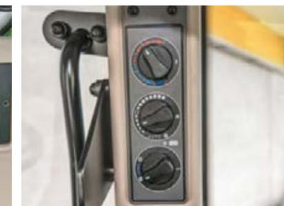
Einfache Klima- und Heizungsbedienug, auf Wunsch mit Fußbodenheizung für den Einsatz im Winter.
