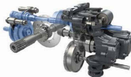
Das Fendt Variogetriebe ML75 ist ein stufenlos-leistungsverzweigter Fahrtrieb mit einem Fahrbereich. Für den ausgezeichneten Wirkungsgrad über den gesamten Geschwindigkeitsbereich sorgen die um 45° schwenkbaren Hydrostaten und die Leistungsverzweigung über einen Planetensatz.
