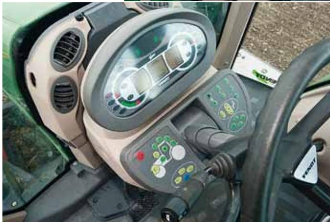
Auf dem Armaturenräger liegt noch die Bedienung vom Arbeitslicht und der Klimaanlage.
