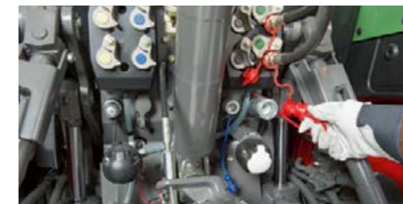
Power Beyond im Heck ist für den Betrieb anspruchsvoller Hydraulikgeräte verfügbar. Ihnen steht die volle Hydraulikleistung ohne unnötige Widerstände direkt zur Verfügung. Der drucklose Rücklauf mit großem Querschnitt hat einen geringen Widerstand.
