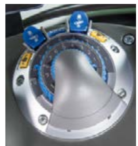
Intuitive Bedienung bietet das kompakte Kraftheberbedienmodul (EHR) und die Zapfwellenbedienung.
