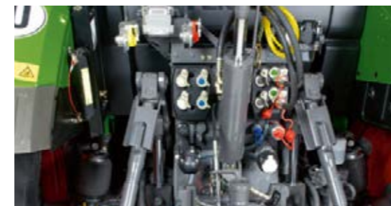
Die Hydraulikkupplungen im Heck sind sauber nebeneinander, farbig gekennzeichnet. Die Staubkappen schließen selbstständig. Für leichtes Ankuppeln sind die Anschlüsse versetzt und unter Druck kuppelbar.
