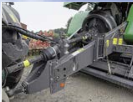
Mit der nach hinten versetzten Kugel ist die Wendigkeit super. Was fehlt, ist ein ordentlicher Schlauchgalgen.
