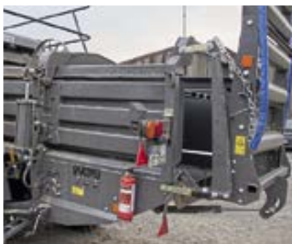
Ballenausstoßer und Rollenschurre werden hinten bedient. Die Waage ist in der Schurre integriert, die Feuchtemessung sitzt oben.
