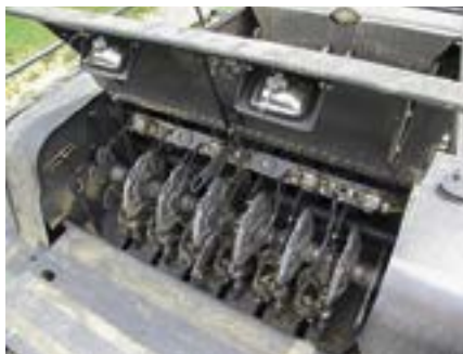
Ein serienmäßiges(!) Tangentialgebläse hält die Doppelknoter tiptopp sauber. Auch die Knoterschmierung ist Serie.
