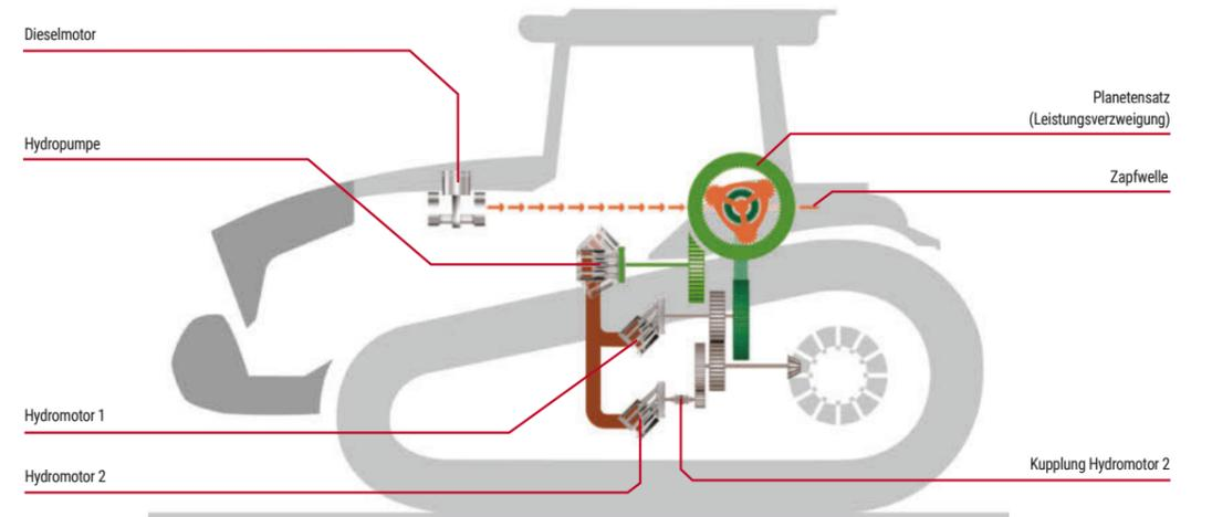
schematischer Aufbau des Antriebskonzepts Fendt VarioDrive
