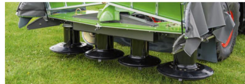
Leicht hochschwenkbare Schutze erleichtern die Reinigung und Wartung enorm. Alle Fendt Cutter sind sehr gut zugänglich.
