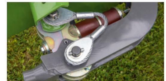
Die Anfahrsicherung schützt das Mähwerk im Falle einer Kollision und rastet beim Rückwärtsfahren wieder automatisch ein.
