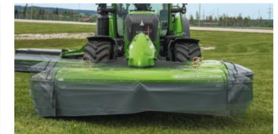
Dank eines Pendelwegs von +/- 5° passen sich die Fendt Cutter FPV dem Boden sehr gut an und lassen keinen Halm stehen.
