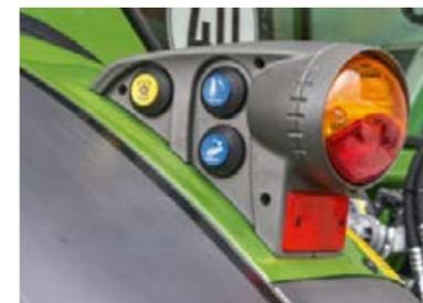
Die Externbedienung für das Hubwerk und die Heckzapfwellenschaltung. Damit bauen Sie Heckgeräte sicher an und sparen sich unnötige Wege, beispielsweise beim Befüllen des Gülleffasses.
