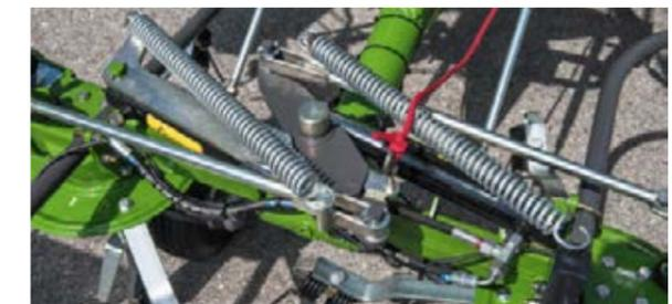
Die Synchronaushebung sorgt beim Arbeiten in Hanglagen für Sicherheit beim Klappvorgang.
