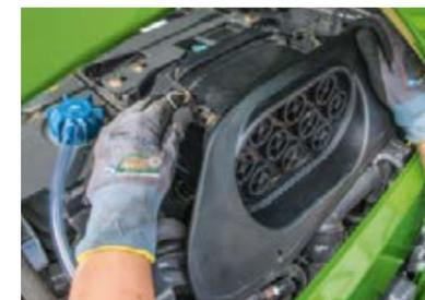
Beste Zugänglichkeit – wie hier beim Luftfilterwechsel – zeichnet alle Fendt Vario Traktoren aus und hält die Wartungszeiten gering.
