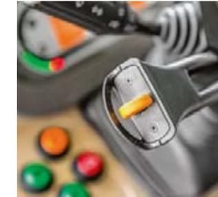
Im Heckanbaubereich sind alle Anschlüsse farbig klar gekennzeichnet und aufgeräumt angeordnet. Die selbstschließenden Ventilkappen verhindern Schmutzeintrag.
