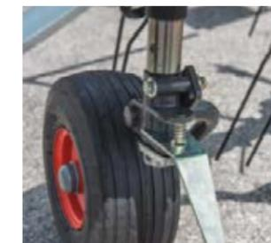
Die serienmäßige Randstreueinrichtung wird schnell und einfach über einen Hebel an den Kreiselrädern verstellt.
