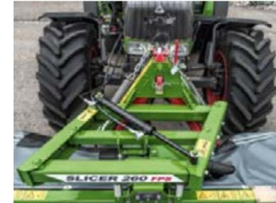
Zwei Federn sorgen dafür, dass das Mäherwerk immer in der Mitte zentriert ist; ein Aufschaukeln beim Transport und im Vorgewende wird zuverlässig verhindert.
