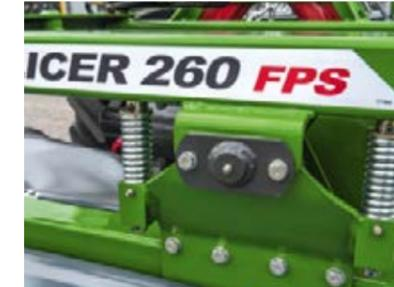
Durch den nahe am Traktor liegenden Koppelpunkt ist das Gespann sicher unterwegs, auch im steilen Gelände.
