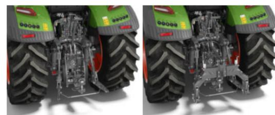
Heckkraftheber mit Kugelenden und Rub Blocks
