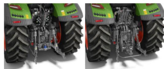
Heckkraftheber mit Schnellfanghaken und Seitenabstützung (EU)
