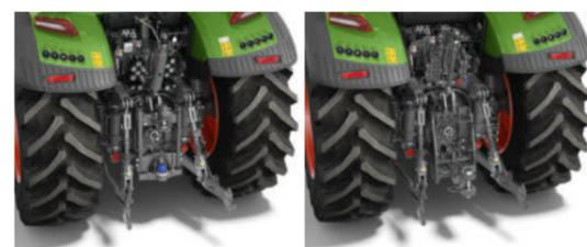
Heckkraftheber mit Schnellfanghaken und Seitenabstützung (EU)
