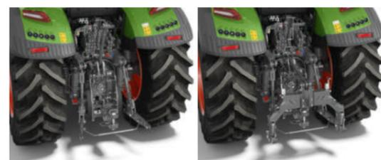
Heckkraftheber mit Kugelenden und Rub Blocks
