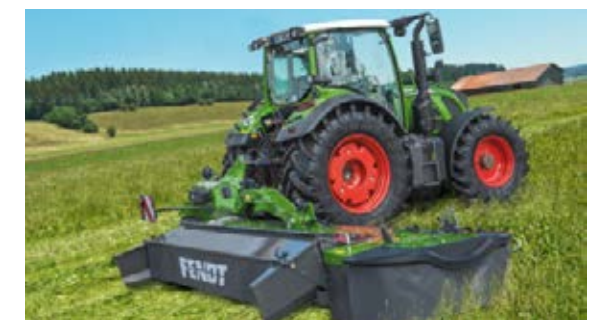
Mit der mittigen Aufhängung passen sich die Mähwerke perfekt an den Boden an.
