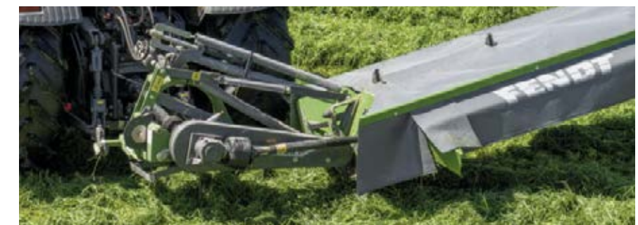
Die Federentlastung sorgt für niedrigen Bodendruck und schont die Grasnarbe.
