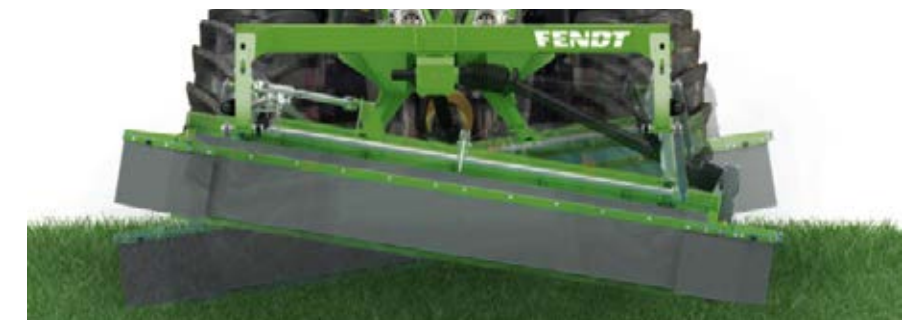
Der große Pendelweg von 20° sorgt auch bei Unebenheiten und am Hang für eine hervorragende Boden Anpassung.
