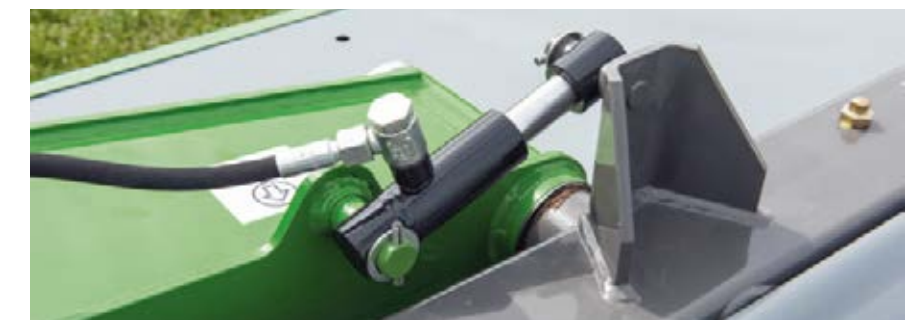
Nach dem Ausheben kalibriert sich das System jedes Mal neu, damit Sie stets mit dem eingestellten Druck arbeiten.
