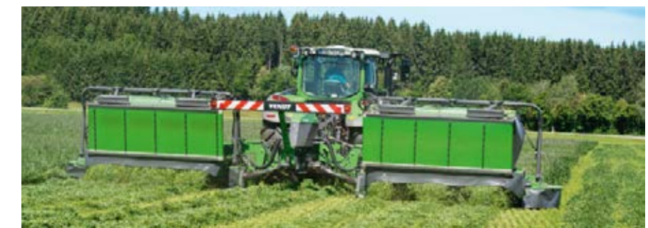
Per Knopfdruck klappen Sie die Bänder nach oben und legen das Erntegut auf der gesamten Breite ab.
