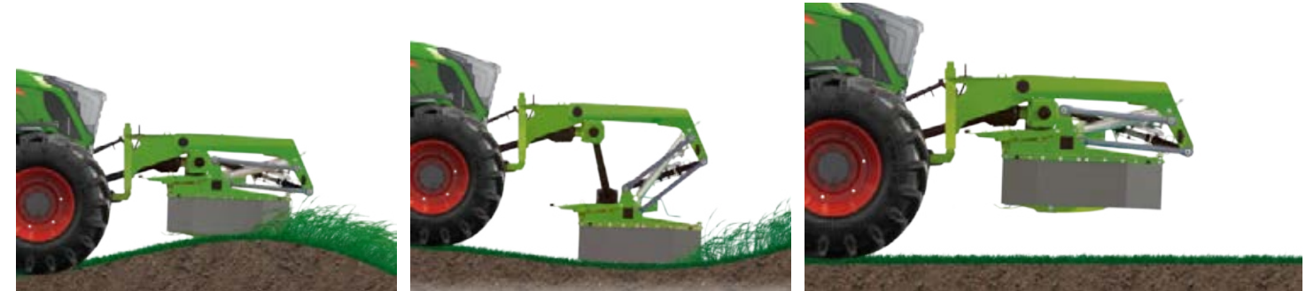
Die Fendt Slicer FZ Scheibenmäherwerke passen sich mit dem Zugbock perfekt der Bodenkontur an.
