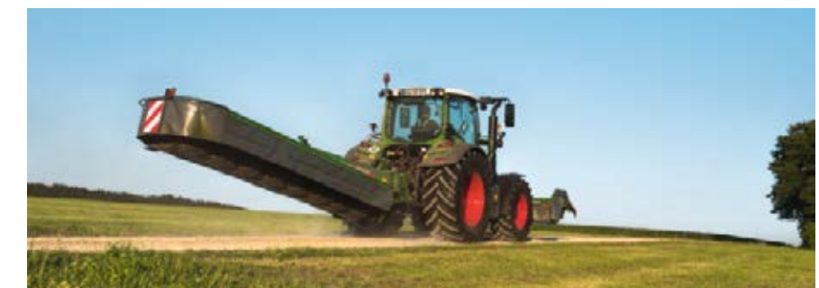
In Transportstellung wird das Mähwerk aus der Kabine um 90° nach hinten geschwenkt.
