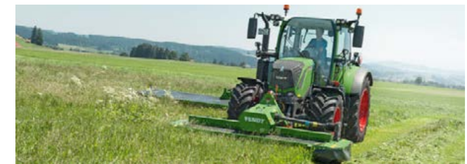
Die Fendt Slicer 310 FPK bauen dank speziellem Pendelbock besonders nahe am Traktor und sind somit äußerst wendig.
