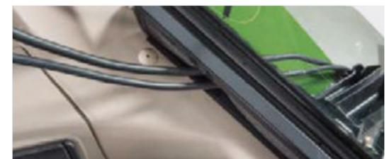
■ Für Kabel, die vom Heck in die Kabine geführt werden müssen, bietet Fendt eine ausgeklügelte Lösung an. Unabhängig vom Querschnitt kann jedes Kabel sauber durch die Durchführung verlegt werden. Die Heckscheibe kann dabei geschlossen werden und Staub, Schmutz, Wasser und Geräusche bleiben draußen.
