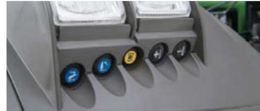
■ Mit der externen Bedienung betätigen Sie den Heckkraftheber, ein Ventil und die Zapfwelle direkt an den hinteren Kotflügeln. Auch bei der externen Betätigung der Heckzapfwelle kann automatisch eine voreingestellte Motordrehzahl angefahren werden. So sparen Sie sich unnötige Wege, zum Beispiel zum Befüllen des Güllefassens.
