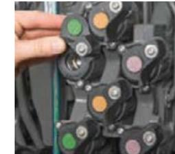
□ Die DUDK-Kupplungen (doppelseitig unter Druck kuppelbar) erleichtern den Geräteanbau und -abbau bedeutend. Die selbstschließenden Ventilkappen schützen sicher vor Verschmutzungen und ermöglichen das Anschließen einer Hydraulikleitung mit einer Hand.
