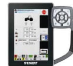
Über das Varioterminal kann der Reifendruck des Traktors mit einem Tastendruck geregelt werden. Über ein Assistenzsystem wird der Fahrer auf zu niedrigen oder zu hohen Reifendruck hingewiesen.
