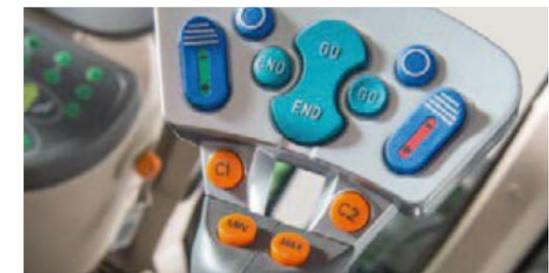
Im Vorgewendemanagement Variotronic<sup>TI</sup> legt der Fahrer im Stand oder während der Fahrt den Bedienungsablauf beim Wenden an und speichert ihn. Einstellungen für die Motor- und Getriebesteuerung, die Hydraulikventile und die Front-/Heckkraftheber, die Zapfwellen in Front und Heck sowie die Spurführung und die Reifendruckregelanlage mit ihren jeweiligen Einzelfunktionen werden über das Vorgewendemanagement vorgenommen und ganz einfach abgerufen.
