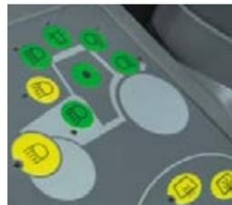
■ Die Beleuchtung lässt sich dank der übersichtlichen Darstellung sehr einfach einstellen. Mit dem Einknopfsystem können alle Arbeitsscheinwerfer mit einmaligem Drücken am Folientaster betätigt werden.
