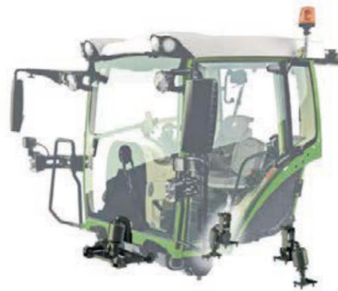
□ Die Kabinenfederung mit Luftfeder-elementen ermöglicht die völlig schwingungsminimierte Kabine. Die große Höhendifferenz und Distanz zwischen den Feder-elementen der x5-Kabine verhindert zudem die Nickbewegungen und sorgt so für höchsten Fahrkomfort.
