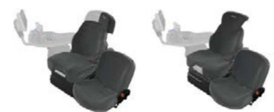
□ Der luftgefederte Super-Komfortsitzevolution dynamic Dualmotion verfügt über eine anpassungsfähige Rückenlehne, Sitzheizung, Niederfrequenzfederung, pneumatische Lendenwirbelstütze und Armlehnenverstellung. Der Sitzbezug ist in schwarzem Stoff oder schwarzem Glattleder in Kombination mit Lederlenkrad erhältlich.
