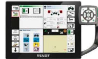
Je nach Belieben lassen sich die Funktionen für die ISOBUS-Gerätesteuerung und das Vorgewendemanagement auf den Multifunktionshebel legen. Variotronic<sup>TI</sup> automatisch ermöglicht in Kombination mit der Spurführung VarioGuide die automatische Aktivierung der Sequenzen am Vorgewende.
