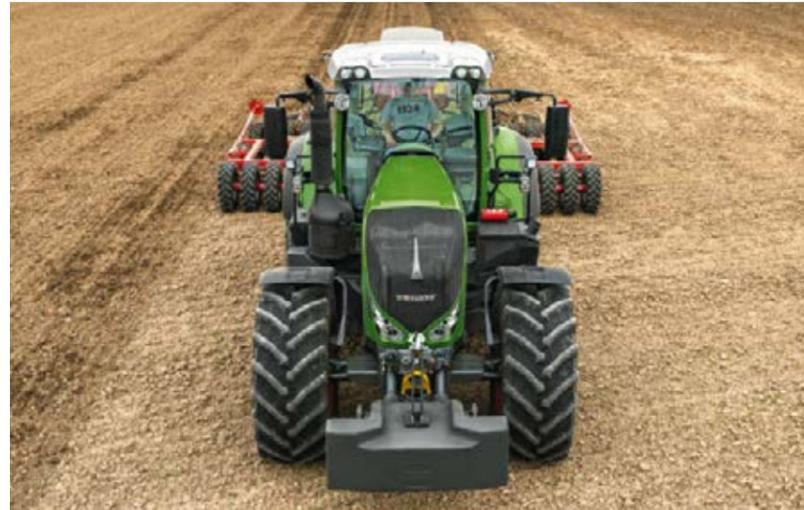
Der Fendt 800 Vario ist auf optimale Übersicht getrimmt. Die Haube ist möglichst schlank gehalten, so dass der Fahrer eine sehr gute Sicht auf den Radlauf und Frontgeräte hat.
