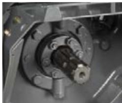
Die Zapfwelle zeichnet sich durch einen überragenden Wirkungsgrad aus, da der Kraftfluss zum Zapfwellenstummel über einen direkten Durchtrieb durch das Variogetriebe erfolgt. Zugleich werden die Normdrehzahlen bereits mit einer Motordrehzahl von unter 2.000 U/min erreicht, was sich positiv auf den Kraftstoffverbrauch auswirkt.
