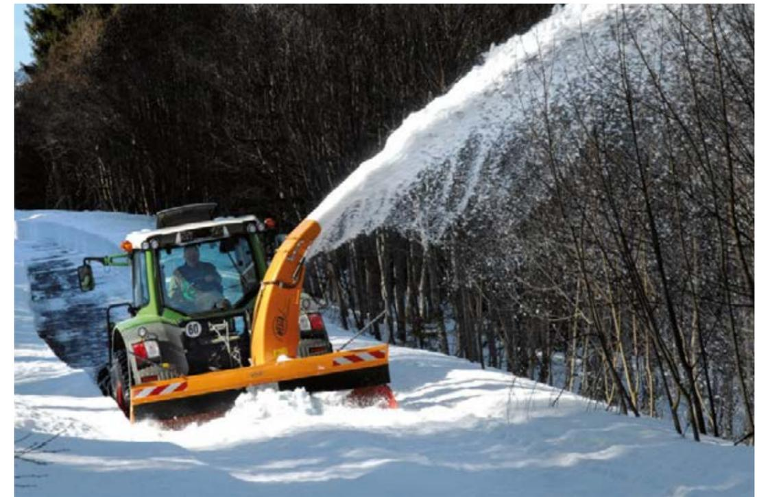
□ Der Fendt 800 Vario ist ideal für den Einsatz im Rückfahrbetrieb geeignet, da der komplette Fahrerstand um 180° gedreht werden kann.
