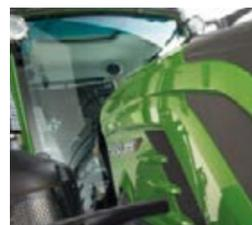
□ Bei Fendt werden die Scheiben der Kabinen eingeklebt, nicht eingeklemmt. Dies verbessert nicht nur das Sichtfeld des Fahrers. Vor allem werden Quietschgeräusche und Undichtigkeiten vermieden. Zusätzlich ist sie beheizbar.
