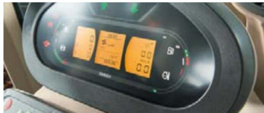
■ Die Innenbeleuchtung im Fendt 800 Vario ist perfekt auf die jeweils wichtigen Bereiche ausgelegt. Ob am Tag oder bei Nacht, die wichtigen Bedienelemente werden angenehm hinterleuchtet. Je nach Lichtverhältnissen wird die Intensität der Hintergrundbeleuchtung im Varioterminal über einen Lichtsensor automatisch geregelt.
