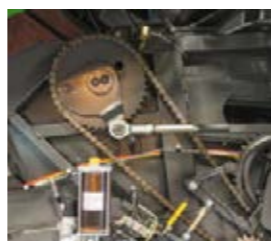
■ Bei der automatischen Ketten- und Knoterschmierung aller Knoter und wichtigen Antriebsketten kann das Schmierintervall bequem über das Terminal eingestellt werden.
