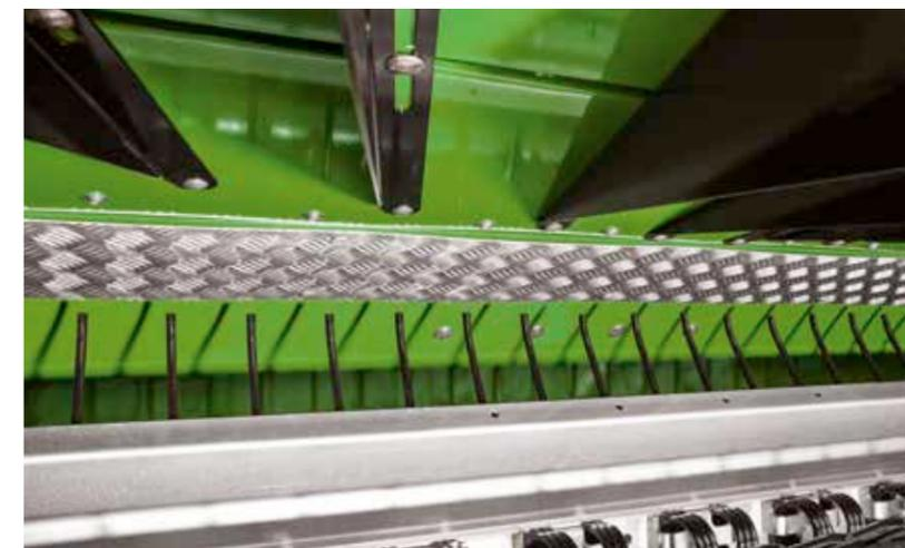
Flexible Zinken mit Einkerbung und ein Riffelblech unterstützen bei der schonenden Futteraufnahme und der effizienten Lösung der Wachsschicht an der Blättern und Stängeln.
