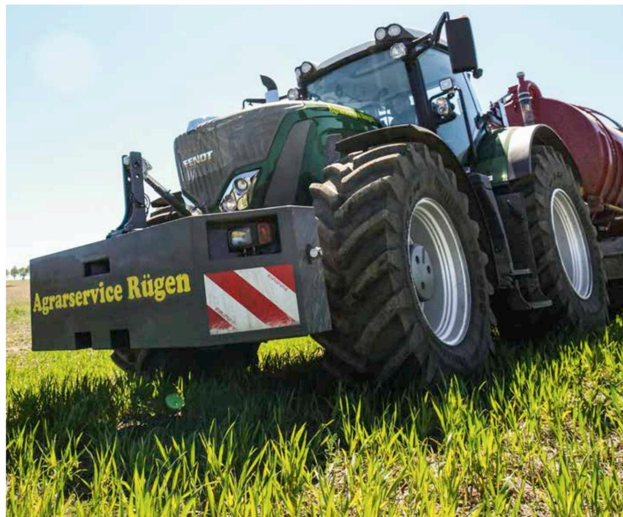
nic dann ihre Berechtigung. Der genaue Anschluss bei der Gülleausbringung ist nur mit dem Spurführungssystem VarioGuide möglich. Das RTK-Signal, welches vom NovAtel-Empfänger aufgenommen wird, bringt den Gülleverteiler auf die richtige Spur.
