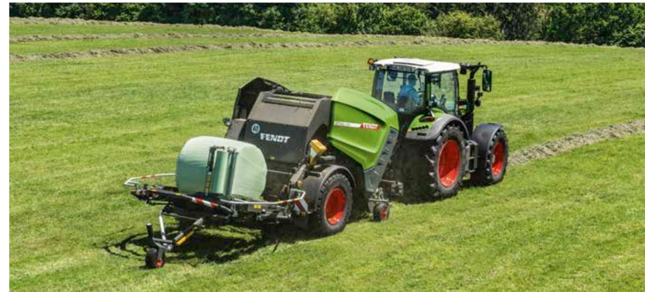
„Durch die verbesserte Anordnung der Presswalzen und die neue Presskammergeometrie versprechen die Fendt Rotana Festkammermodelle einen höheren Futterdurchsatz, eine größere Ballendichte und eine sichere Ballenrotation.“
