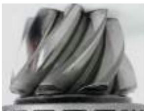
Kegelrad nach 300 Stunden mit Originalschmierstoff
