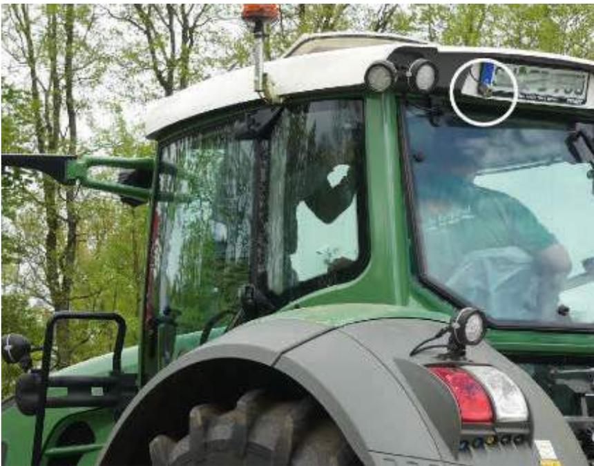
Rückfahrkamera am Traktordach
