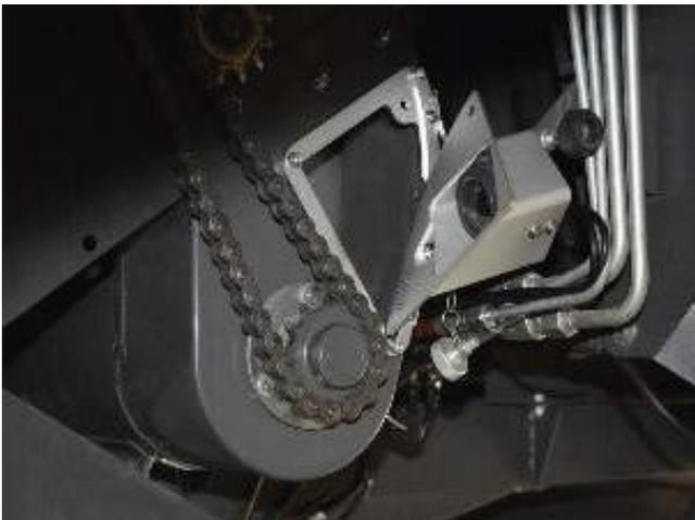
Überkehr-Kamera mit geöffneter Klappe
