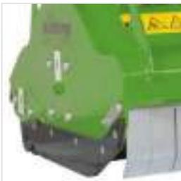
Schmal und vertikal ausgeführte seitliche Verschleißkufen verhindern Scherwirkung und Verletzungen des Bestandes durch Abdrift am Seitenhang.
