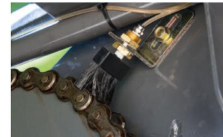
Neu ist eine automatische Kettenschmierung aller wichtigen Antriebsketten. Das Schmierintervall wird bequem über das Terminal eingestellt.
