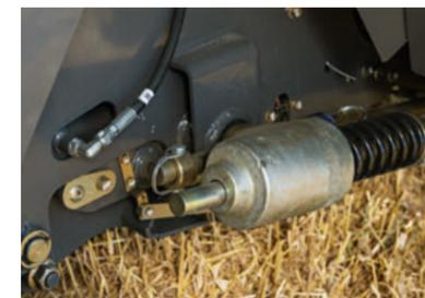
Die gewünschte Absenkhöhe wird werkzeuglos durch das Anheben der Pick-Up und das Einsetzen des Splintes in das entsprechende Loch eingestellt.
