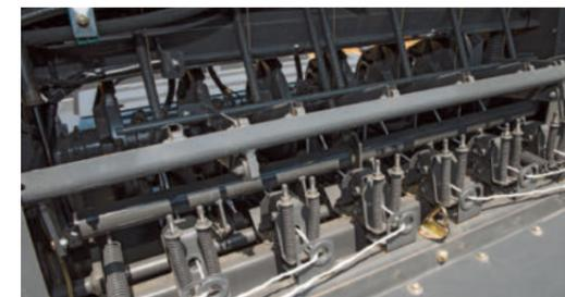
Die saubere Führung des Garns durch die Knoterbremsen sorgt für eine gleichmäßige Garnzuführung zum Knoter.
