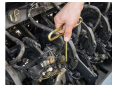
Die einzeln hochklappbaren Knoter ermöglichen einen optimalen Zugang für Wartung und Service.
