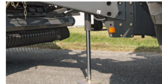
Der hydraulische Stützfuß ermöglicht ein einfaches und schnelles An- und Abhängen des Traktors.
