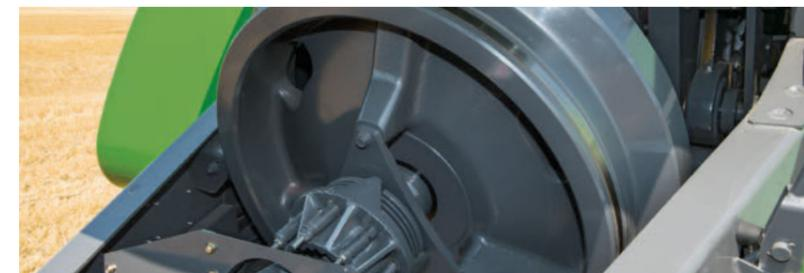
Das 545 kg schwere Schwungrad bietet einen gleichmäßigen und ruhigen Lauf der Presse bei gleichzeitig hoher Kraftübertragung.
