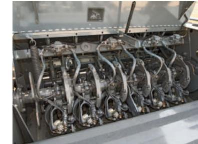
Einen einfachen Zugang zu den Knotern gewährleistet eine große Wartungshaube und das klappbare Querstromgebläse.
