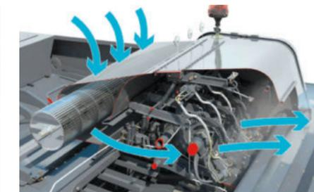
Das serienmäßige Querstromgebläse sorgt für einen permanenten Luftstrom über den gesamten Knoterbereich, welcher jegliche Fremdkörper gründlich aus dem Knoterbereich entfernt.
