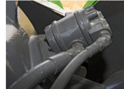
Die Presskammerklappen werden automatisch über die doppeltwirkenden Hydraulikzylinder am Presskanal gesteuert.
