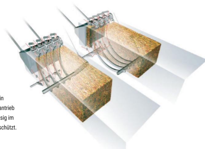
Nichts wird dem Zufall überlassen. Über ein Sicherheitsgestänge, das mit dem Kolbenantrieb verbunden ist, werden die Nadeln zuverlässig im Falle eines gebrochenen Scherbolzens geschützt.
