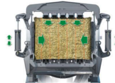
Die Vorpresskammer wird kontinuierlich vom Raffer befüllt. Erst wenn die Vorpresskammer voll ist, löst die im Vorpresskammer-Boden befindliche Sensorklappe den Förderrechen aus. Die Rückhaltefinger werden nach hinten gezogen und geben den Zugang zum Hauptpresskanal frei.
