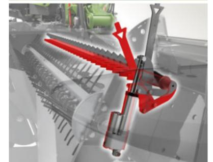
Ein Elektromotor steuert stufenlos den Gegenkamm des Aufbereiters, welcher für die Intensität der Aufbereitung verantwortlich ist.
