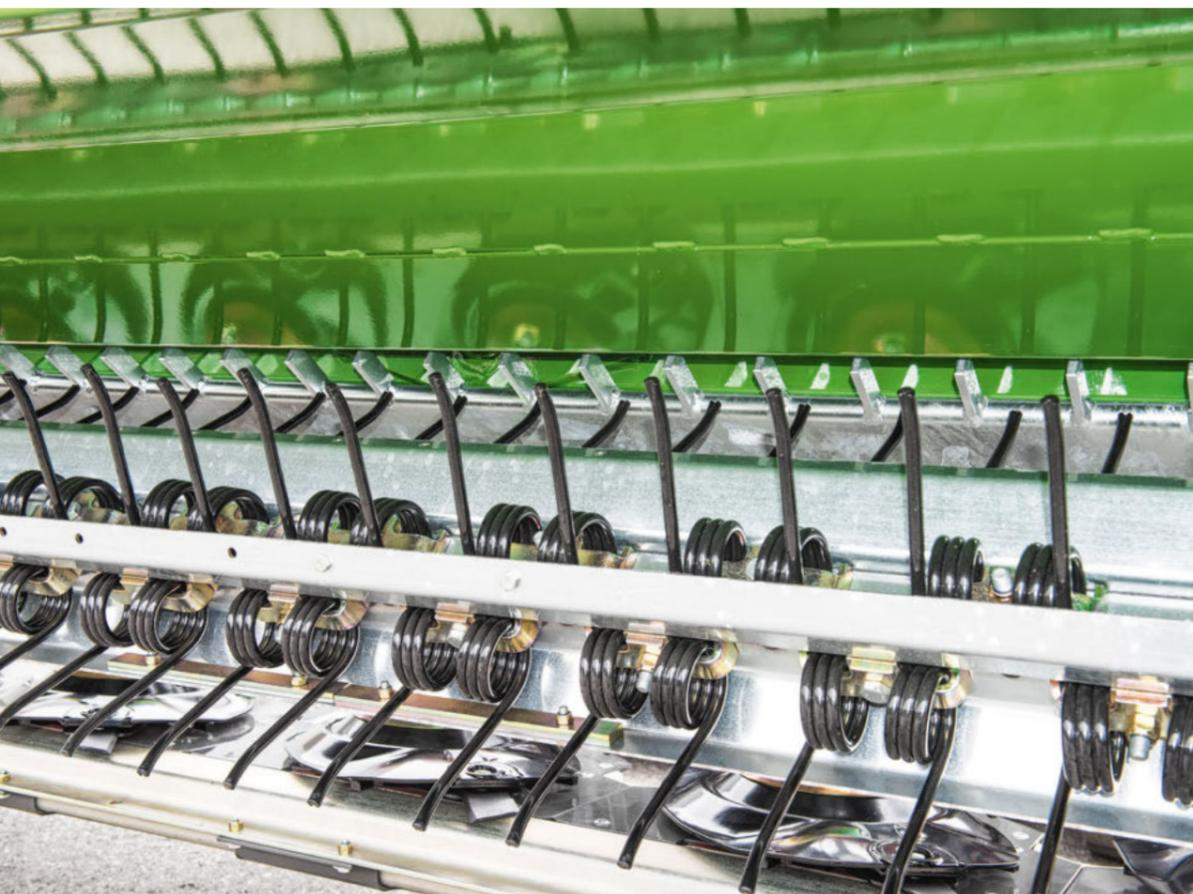
Zinkenaufbereiter: Aggressiver als der Rollenaufbereiter. Grasbestände, Ackerfutter etc.
