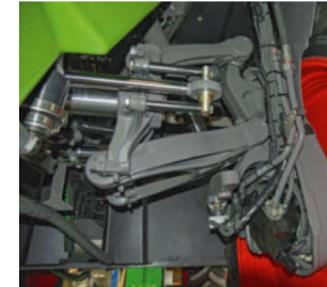
Die Anhängerkupplung ist für eine Zuglast bis 16 t ausgelegt. Die Anschlüsse für Luft und Licht sind einfach zu erreichen.
