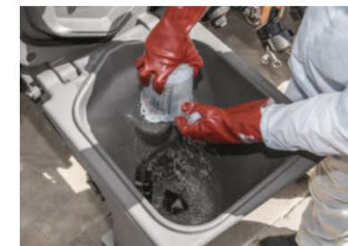
Mit der rotierenden Spüldüse in der Einspülschleuse können Messbecher und Kanister bequem und sicher ausgespült werden.
