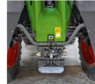
Die Spurweite kann, je nach Bereifung, zwischen 1,80 und 2,25 m stufenlos verstellt werden.
