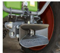
□ Automatisches Zugmaul mit Brems- und Elektroanschlüssen.
