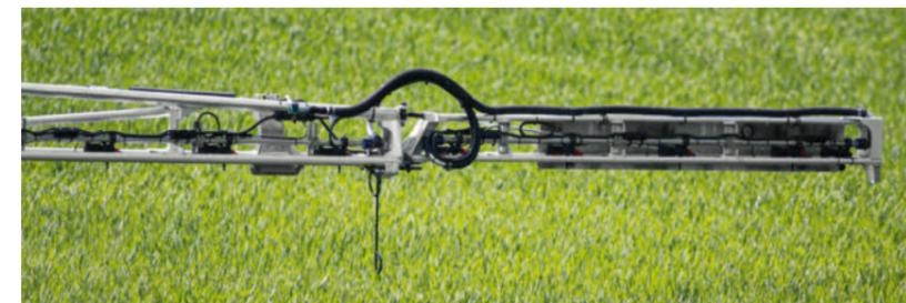
Die Fendt Rogator Anfahrssicherung kann bis zu 90° wegdrehen. Die Rückschwenkbewegungen sind gedämpft, sodass keine zusätzlichen Impulse auf das Gestänge einwirken.
