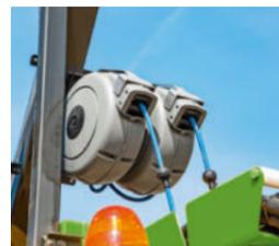
□ Schlauchaufroller zur komfortablen Außenreinigung.
