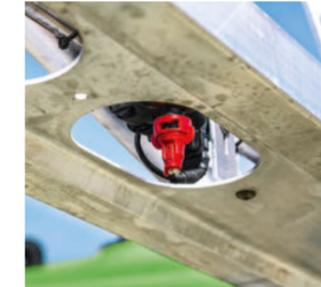
Auch beim Einsatz von Doppelflachstrahldüsen oder Düsen mit einem Abstrahlwinkel nach hinten oder vorn trifft jeder Tropfen die Zielfläche.
