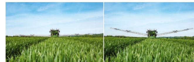
Durch die positive und negative Anwinkelung des Gestänges auf dem Feld kann die optimale Applikationshöhe jederzeit eingehalten werden.
