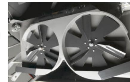
Ein mehrfach verstellbarer Spreuverteiler mit Doppelrotor ist optional erhältlich.
