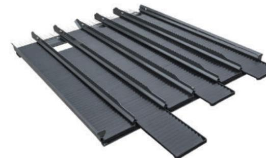
Gerade in sehr feuchten Erntebedingungen sorgt ein sauberer Vorbereitungsboden für eine stets hohe Durchsatzleistung und optimale Druschqualität. Deswegen ist der Vorbereitungsboden der Fendt L-Serie einfach und leicht zu entnehmen.
