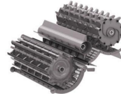
Der Abscheidekorb befindet sich komplett oberhalb des Multi Crop Separators. Diese Einstellung ist besonders bei leicht ausdreschenden Erntegütern und trockenen Bedingungen empfehlenswert, denn dadurch bleibt die Strohstruktur erhalten.
