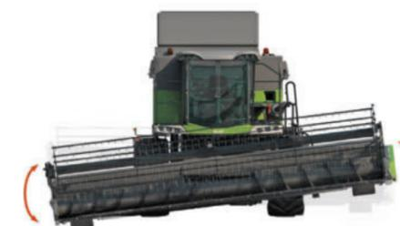
Die serienmäßige AutoLevel-Schneidwerksregelung sorgt für eine konstante Schnitthöhe über die gesamte Breite.
