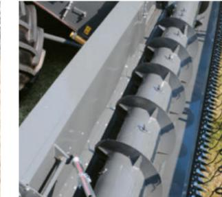
Der Power Feed Roller führt das Erntegut sehr gleichmäßig vom Schneidwerk in den Schrägförderer.
