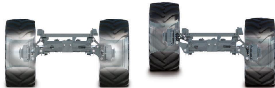
Einfaches Wechseln zwischen Arbeits- und Transportmodus mit dem ParaLevel-System, das Hanglagen bis zu 20 % ausgleicht.
