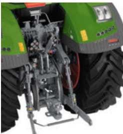
Heckkraftheber mit Kugelen und Rub Blocks
