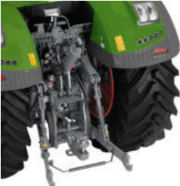
Heckkraftheber mit Schnellfanghaken und Rub Blocks (AU)
