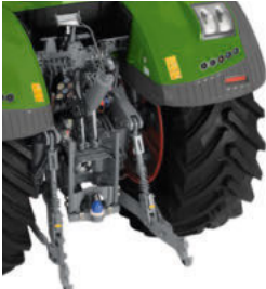
Heckkraftheber mit Schnellfanghaken und Seitenabstützung (EU)
