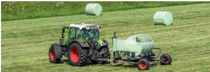
Der Fendt Rollector wickelt Ballen mit einem Durchmesser von 0,90 m bis 1,30 m.
