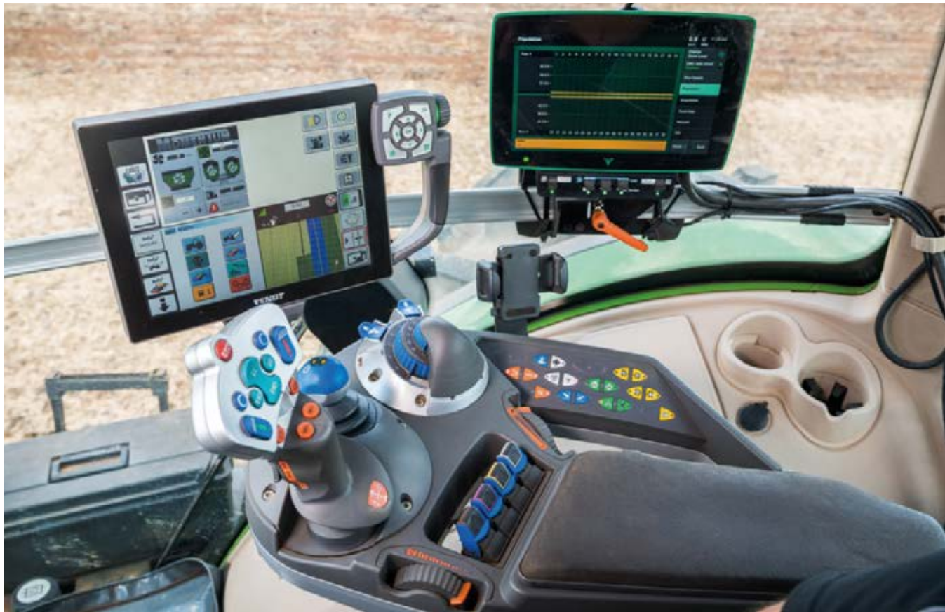
Em modo de condução reversível, todos os elementos de controle podem ser operados de forma tão confortável como em modo de condução para a frente. Toda a estação de condução é rotacionada de uma forma simples a 180°. Todo o resto da cabine mantém-se na mesma posição. Tudo a bordo do assento conforto.
