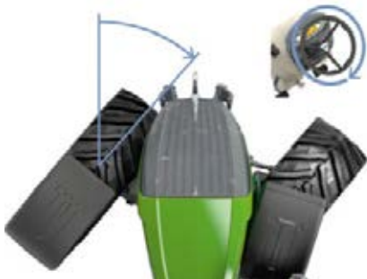
Com o VarioActive, você faz uma volta completa da direção com apenas uma volta do volante.
