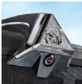
Prático para implementos montados à frente: a nova câmera integrada no capô captura imagens dos braços inferiores e as transmite para o Varioterminal.
