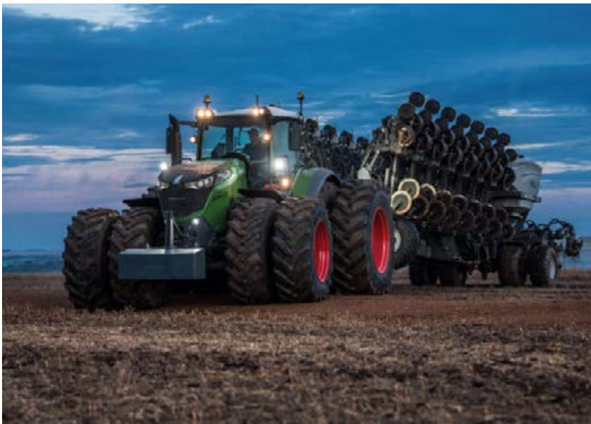
O Fendt 1000 Vario garante um excelente desempenho à noite com a nova geração de luzes de trabalho LED com 61.100 lúmens. Quer esteja equipado com luzes LED ou de halogéneo, toda a área de trabalho é completamente iluminada. O interior da cabine também torna o trabalho noturno muito agradável: todos os elementos operacionais são retroiluminados e iluminam-se automaticamente quando escurece. Com a funcionalidade "volta pra casa", a cabine e as luzes de condução continuam acesas após a parada do trator.
