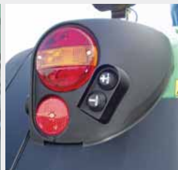
Externbedienung Hydrauliksteuergerät Heck
