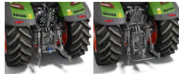
Heckkraftheber mit Schnellfanghaken und Seitenabstützung (EU)
