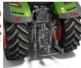
Heckkraftheber mit Schnellfanghaken und Rub Blocks (AU, Südafrika, Osteuropa)
