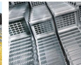
Die sogenannten aktiven und geöffneten Rückwände der Fallstufen verbessern nochmals die Restkornabscheidung.
