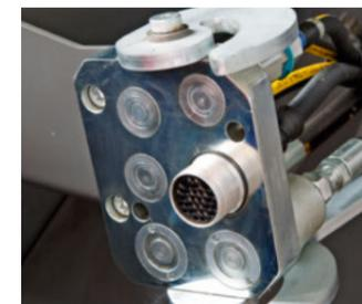
Der optionale Multikuppler ermöglicht das schnelle Umrüsten beim Feldwechsel.
