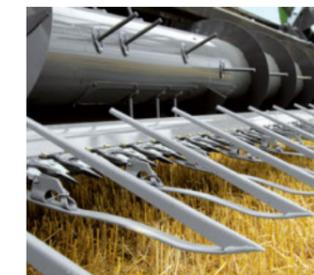
Am FreeFlow-Schneidwerk erhöhen über die gesamte Breite angeordnete Einzugsfinger den Durchsatz der Einzugsschnecke und gewährleisten eine aktive und schnelle Zufuhr in den Schrägförderer.
