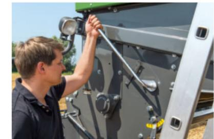
Durch Umlegen eines Hebels können Sie schnell und einfach zwischen Schwadablage und Häckseln wählen.
