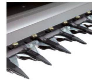
Das Schumacher-Messersystem ist das Beste der Branche. Es leistet 1.220 Schnitte pro Minute, ist selbstreinigend und bleibt stets scharf.
