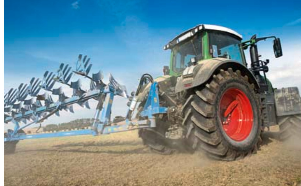
Mehr Zugkraft durch Absenken des Reifendrucks mit VarioGrip.
