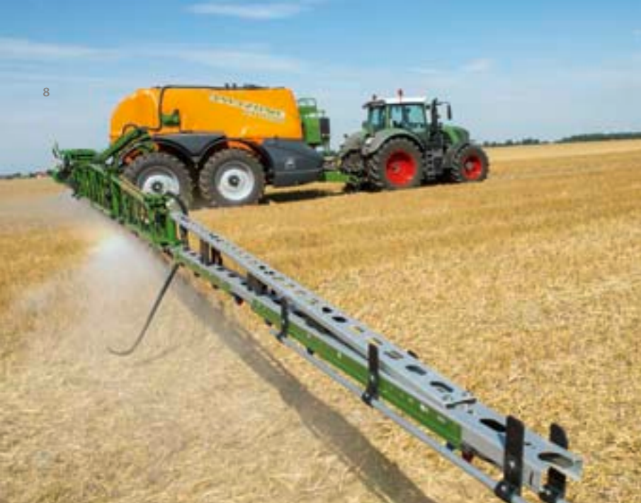
Fendt 800 Vario mit SectionControl: Teilbreitenschaltung über vollautomatisches GPS-Signal.
