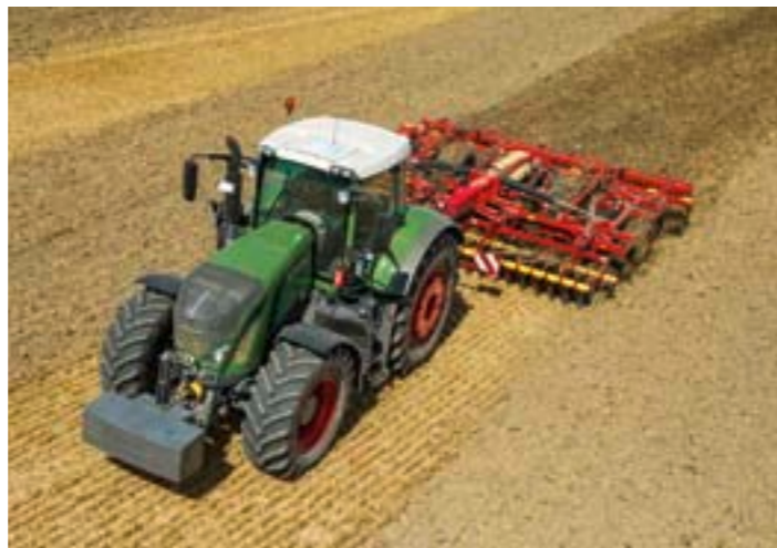
Fendt 939 Vario: Mit flexibler Balastierung wird er zum 18 t schweren Zugschlepper.
