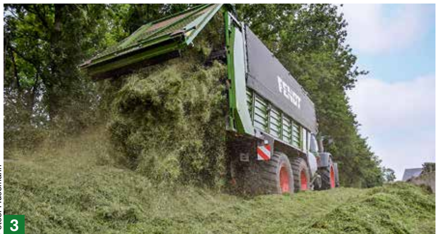
△ 1) Der Kratzboden senkt sich vorne auf einer Länge von 1,60 m um 25 cm. Der Kratzboden ist zweigeteilt. 2) Die Schnittqualität ist gut. Die theoretische Schnittlänge beträgt 37 mm. 3) Die beiden Dosierwalzen haben das Futter locker und gleichmäßig abgelegt. Eine dritte Walze gibt es auf Wunsch.
