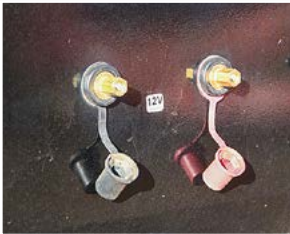
Überbrücken ist dank externer Batteriepole kein Problem.
