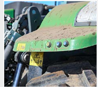
Rechts fehlt die Bedienung für das Steuerventil.
