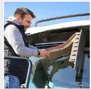
An die Kabinenfilter kommt man nur mit viel Schrauberei.
