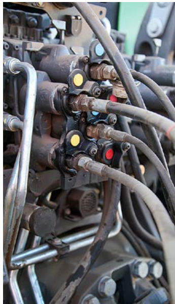
Ordentlich beschriftete Anschlüsse mit Entlastungshebeln – so soll es sein. Optional sind bis zu acht dw-Ventile und 440 l/min Ölfördermenge möglich.
