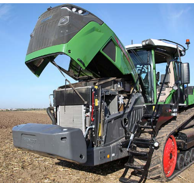
Der MAN-Sechszylinder unter der gewaltigen Haube ist leise und sparsam. Der Kühlerbereich ist komplett vom Motor abgeschottet.
