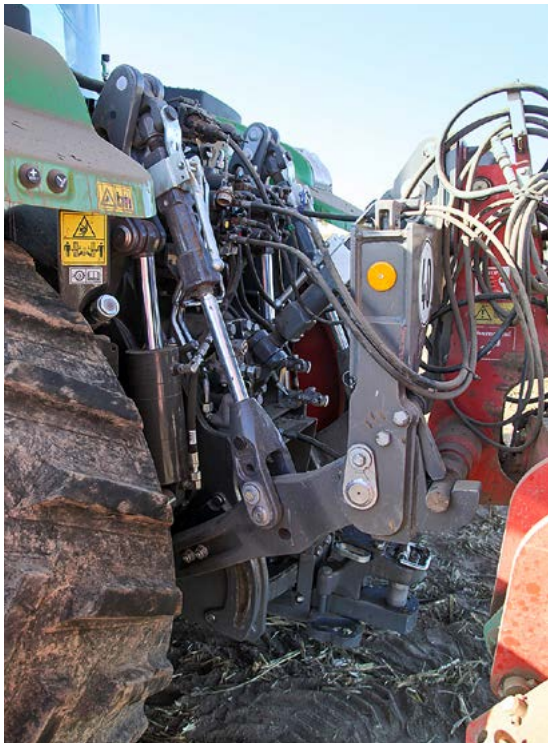
Ordentlich beschriftete Anschlüsse mit Entlastungshebeln – so soll es sein. Optional sind bis zu acht dw-Ventile und 440 l/min Ölfördermenge möglich.
