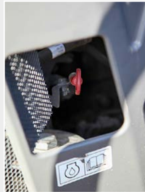
Statt Sensor muss man noch einen Ölpeilstab ziehen.
