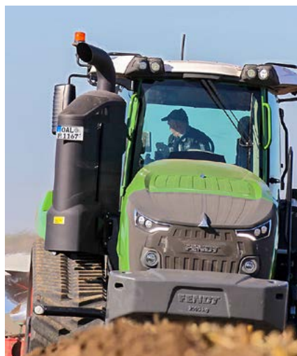
In dem riesigen Auspuff sitzt die komplette Abgastechnik mit DOC, SCR und DPF für die Abgasstufe V.
