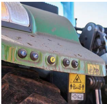
Das Hubwerk hebt fast 10 t, ist aber wie die Zapfwelle für viele eine unnötige Zusatzausstattung. Hier zählt nur das dicke Zugpendel der Kat. V.
