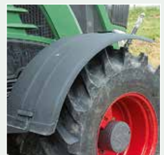
Gespart 2: Die Kotflügel sind (zu) kurz geraten.
