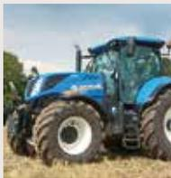
• **New Holland T7.230 AutoCommand:** Die Reihe T7 umfasst acht Modelle von 129 kW (175 PS) bis 198 kW (270 PS). Zur
