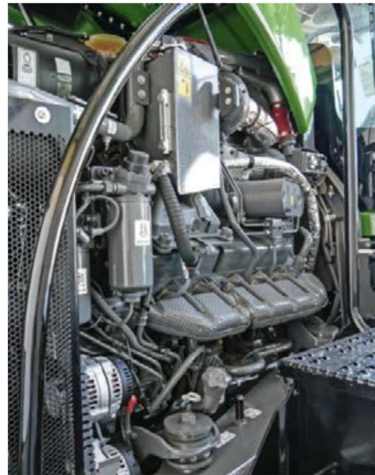
■ Der 12-Zylinder AGCO Power Motor besticht durch seine Laufruhe und gute Wartungszugänglichkeit.
