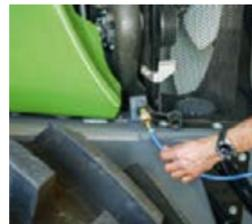
■ An der Front befindet sich ein Druckluftanschluss um den Kühler zu reinigen.
