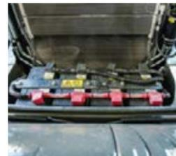
■ Vier wartungsfreie Batterien sorgen für Spannung im Fendt 1100 MT.
