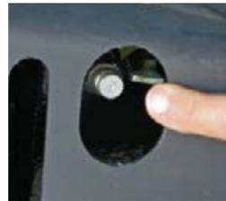
■ Um die Laufbänder zu spannen, sind die Druckanschlüsse leicht zugänglich.
