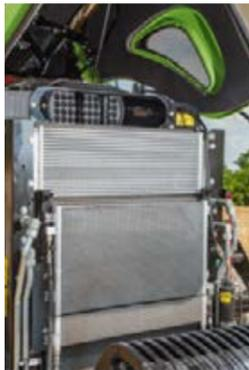
■ Die groß dimensionierten Kühlerpakete sind leicht zu reinigen.
