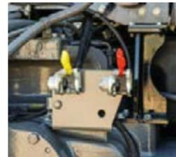
■ Eine vollwertige Druckluftanlage steht für gebremste Anbaugeräte zur Verfügung.
