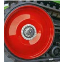
Das Leitrad wird vom Laufbandspanner gegen das Band gedrückt und hält somit die Spannung aufrecht.
