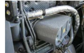
Als zweite Kühlstufe dient der große Ladeluftkühler, der die Ansaugluft deutlich abkühlt und damit die Verbrennung optimiert.
