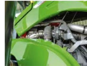
Der iCAC Zwischenkühler kühlt die Ladeluft vor und erhöht somit das Drehmoment.
