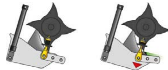
Das Entlastungssystem FlexControl verhindert Blockaden zuverlässig.
