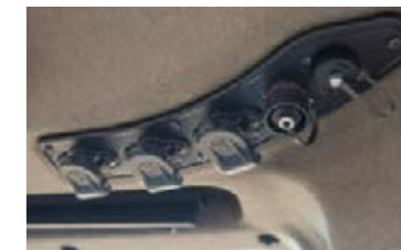
Stromanschlüsse für externe Verbraucher liegen aufgeräumt und gut zugänglich im Dachbereich.
