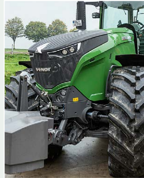
Mit den 3,3 t Ballast wird die Vorderachslast überschritten! Und es gibt keine Frontzapfwelle.
