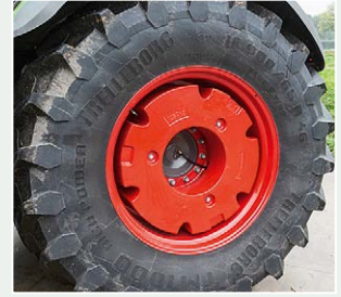
2 x 1,25 t Radgewichte könnten noch einfacher zu de-/montieren sein.
