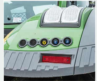
Die externe Hydraulikbedienung rechts ist (erst) seit Mitte 2017 Serie.
