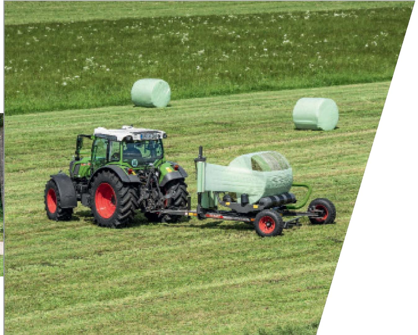
Je nach Futtermaterial und gewünschter Lagerzeit lässt sich die Anzahl der Folienlagen leicht einstellen. Über das Bediengerät kann die Anzahl der Umdrehungen eingestellt werden, um somit die gewünschte Anzahl an Folienwicklungen zu erreichen.
