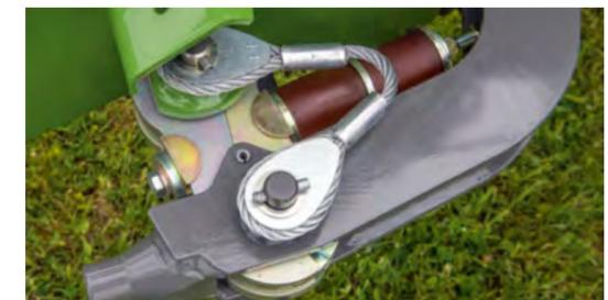
Die Anfahrssicherung schützt das Mähwerk im Falle einer Kollision und rastet beim Rückwärtsfahren wieder automatisch ein.
