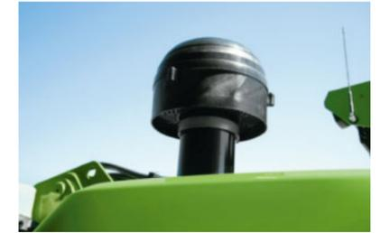
• Zyklonvorabscheider für den Luftfilter
