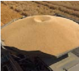
Kapacitet på op til 17.100 l i Streamer 210 tømmes på ca. 81 sekunder.
