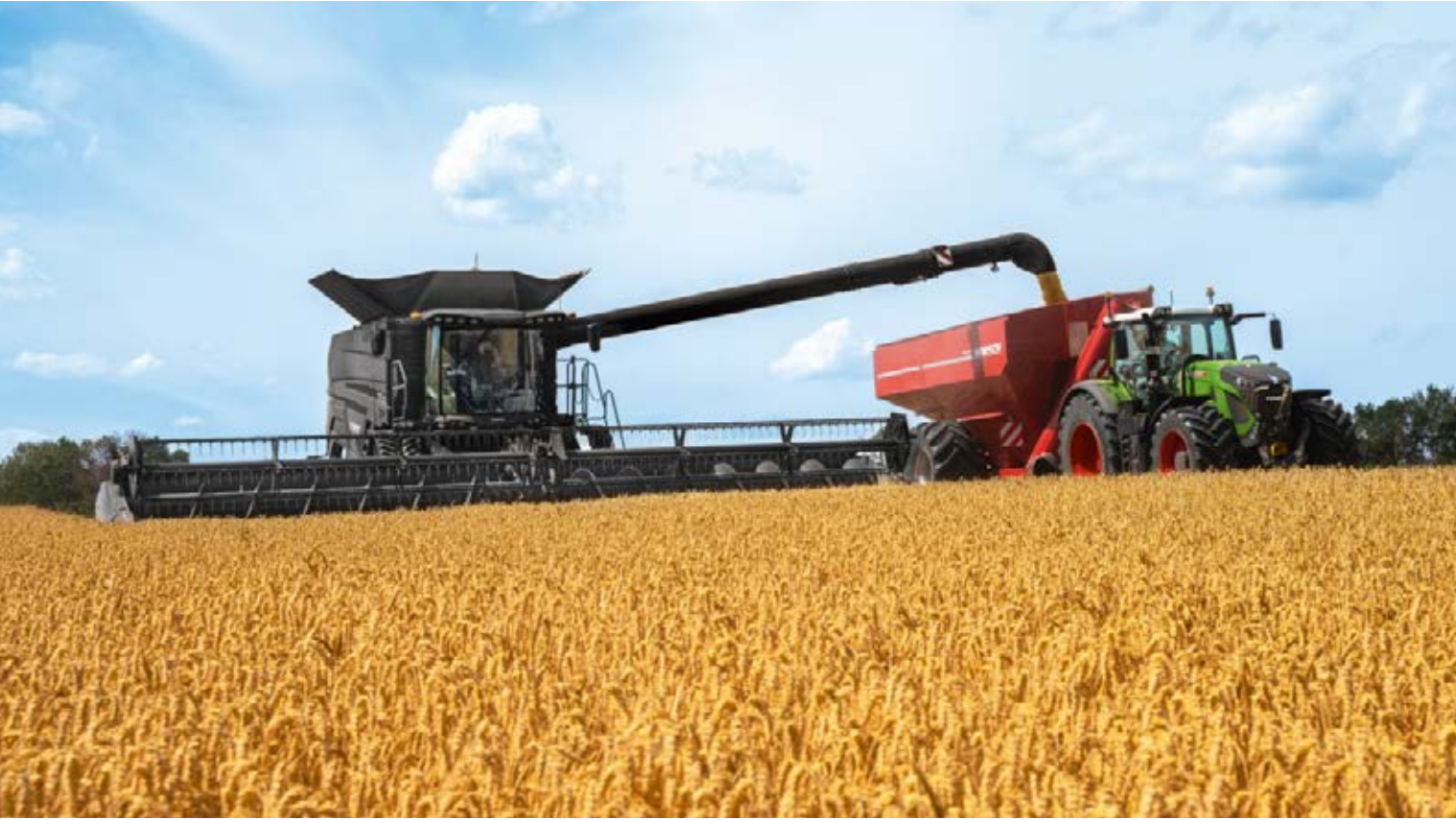
Færre og kortere stop til tømning afspejles hurtigt i et større dagligt udbytte - på elevatoren er der monteret sensorer for udbytte og fugt samt et kornkvalitetskamera. Dataene opnår en nøjagtighed på 98 %, og de anvendes ved hjælp af VarioDoc ISOBUS standarden, live-kortlægning af udbytte og IDEALharvest™.
