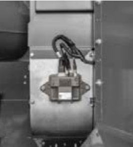
Færre og kortere stop til tømning afspejles hurtigt i et større dagligt udbytte - på elevatoren er der monteret sensorer for udbytte og fugt samt et kornkvalitetskamera. Dataene opnår en nøjagtighed på 98 %, og de anvendes ved hjælp af VarioDoc ISOBUS standarden, live-kortlægning af udbytte og IDEALharvest™.
