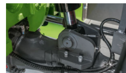
Chassis – Optioner Pendulaksel pære til bagakslen • Funktion 1: pendulerer frit • Funktion 2: automatisk aktivering ved stilstand • Funktion 3: permanent spærret
