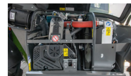
Køling - Optioner • Vendbar ventilator • Aktivering automatisk i 3 intervaller (20, 40 eller 60 min), eller manuel udløsning via trykknop.
