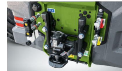
• Automatisk anhængerkobling (Rockinger) • Maks. Anhængerlast 18,5 t
