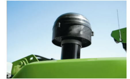
• Cyklonforseparator til luftfilter (udskilningsgrad 98 %)
