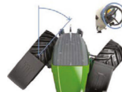
Med VarioActive kan du komme igennem den fulde styrevinkel med blot én drejning af rattet.
