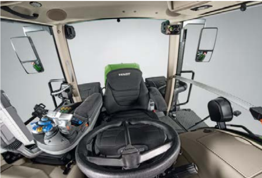
Til anvendelse med anordning til kørsel baglæns drejes førerplatformen helt 180°. Derefter kan du bruge alle dine betjeningselementer lige så komfortabelt baglæns som ved kørsel fremad. Trods den vendbare førerplads behøver instruktøren ikke at undvære komfortsædet.
