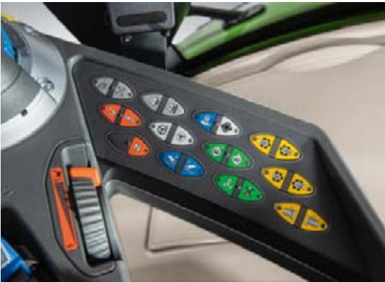
Alle betjeningselementerne er arrangeret enkelt og klart på folietastaturet med baggrundsbelysning.
