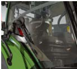
220° vinduesviskeren på kabinens højre rude sikrer det bedste udsyn til højre, selv under de vanskeligste forhold.
