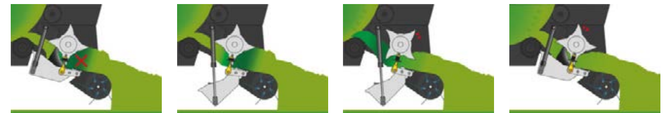
I tilfælde af en blokering sænkes bageste del af knivbunden med 500 mm.
