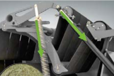
Det lille forkammer sikrer en pålidelig og tidlig kernerotation. Det danner basis for perfekte baller.
