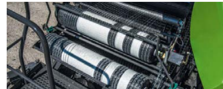
Med EasyLoad-systemet er det hurtigt at lægge ekstra netruller i.
