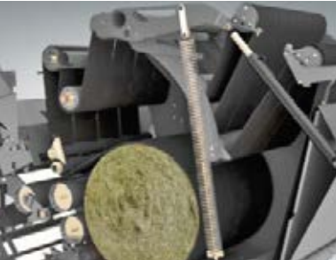
De to forreste rembærende valser driver remmen. Denne dobbelte omslutning af rullerne giver en rotation, der passer til enhver type baller.
