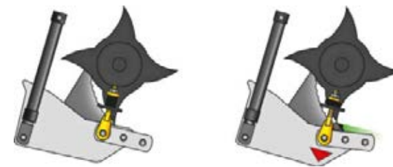
FlexControl aflastningssystemet hindrer blokeringer.
