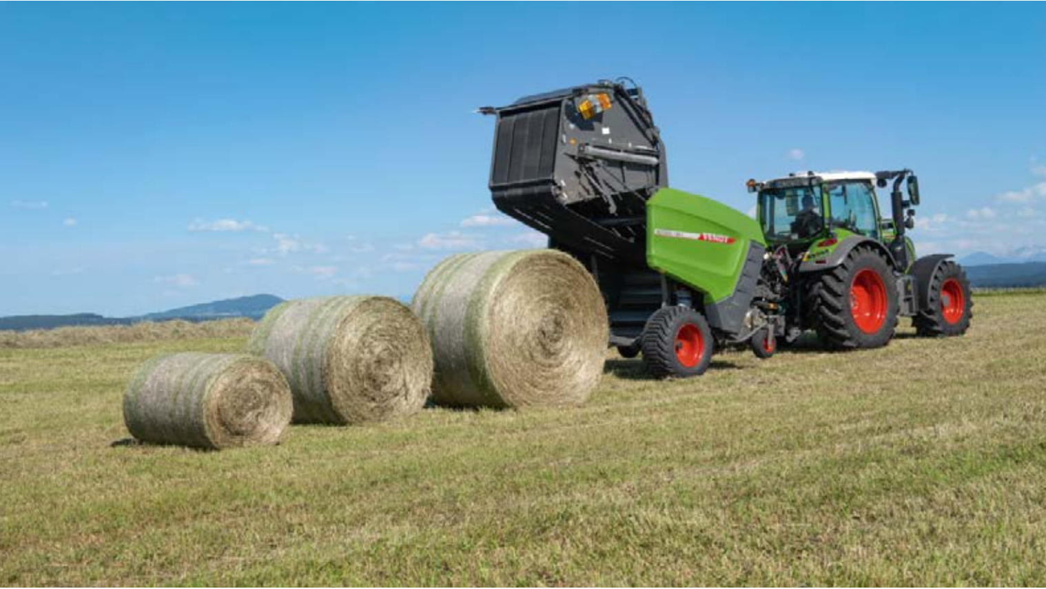
Fendts rundballepressere med variabelt kammer gør det let at presse baller med en diameter fra 0,70 til 1,60 m eller 1,80 m.
