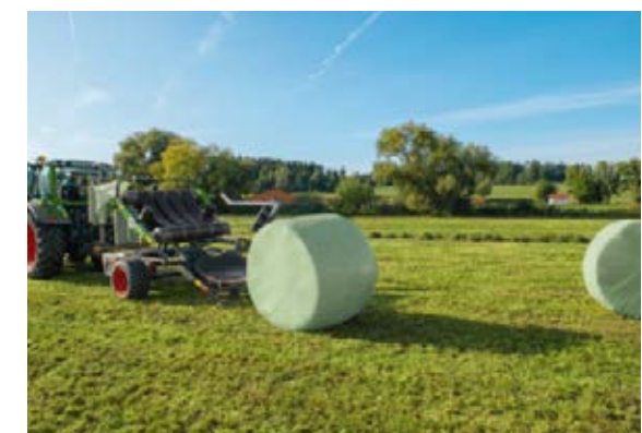
Rollector 160 er forsynet med et balleaflæsserbord med aktiv udtømning – det forhindrer effektivt, at folien bliver beskadiget.
