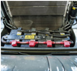
□ Fire vedligeholdelsesfri batterier leverer strøm til Fendt 1100 MT.
