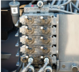
■ Seks hydrauliske ventiler, en lækolietilslutning og PowerBeyond er placeret bagpå.
