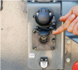
□ Et 12 V-udtag til eksterne enheder er tilgængeligt bagpå. ISOBUS-forbindelsen opretter forbindelse til redskaberne.
