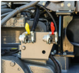
■ Et komplet trykluftsystem er tilgængeligt for visse redskaber.
