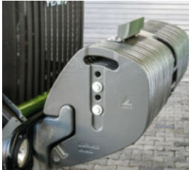
■ Næsten 990 kg vægt kan monteres på forrammen.
