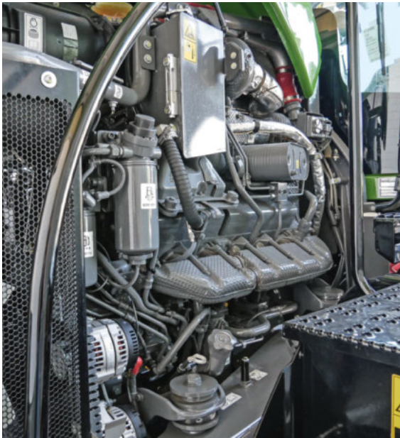
■ Den 12-cylindrede AGCO Power motor overbeviser med sin bløde kørsel og gode adgangsforhold til vedligeholdelse.
