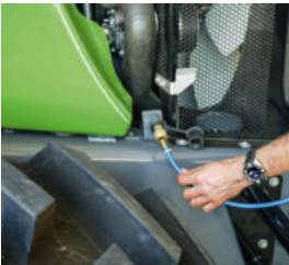
□ Der sidder en trykluftstilslutning foran til rengøring af køleren.
