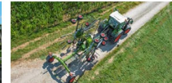
Med den hydrauliske justering af arbejdsbredden er det muligt at justere arbejdsbredden uden at forlade kabinen. På den letlæselige indikator kan du se den aktuelt indstillede arbejdsbredde.
