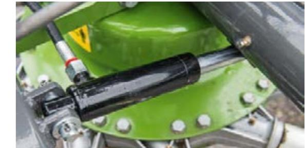
Der sikres en stor frihøje med rotorernes paralleløft takket være en hydraulisk portalaksel.
