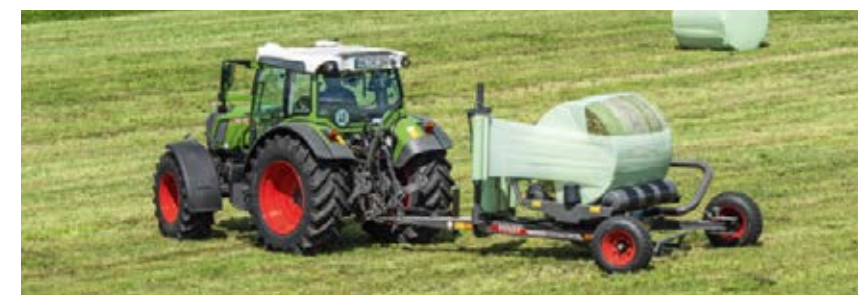
Fendt Rollector pakker baller med en diameter på mellem 0,90 m og 1,30 m.
