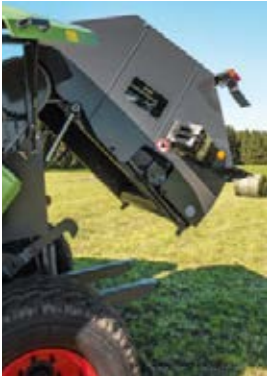
En bolt på bagklappen sikrer, at den kan lukkes sikkert, også på skråninger.
