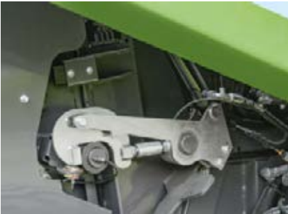
Den mekaniske lås sikrer massive baller, og at bagklappen lukker korrekt.
