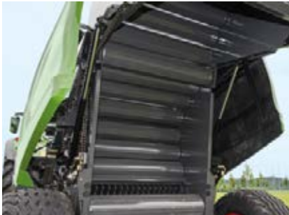
18 PowerGrip valser starter altid rotationen pålideligt og sikrer en ensartet komprimering.
