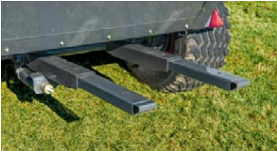
Ballerampen - som kan justeres uden brug af værktøj - giver ballen den ønskede fremdrift og forhindrer sammenstød mellem bagklap og rampe.
