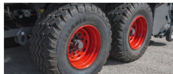
■ Takket være det nye chassis fås Fendt Squadra 1290 UD med forskellig udvendig bredde med forskellige dæk: 620/50R22.5- eller 620/55R26.5-dæk for en udvendig bredde på under tre meter, og maksimal dækstørrelse 710/50R-26.5 for en udvendig bredde på 3,20 m.
