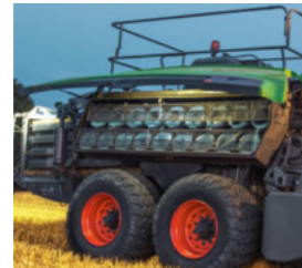
■ LED-arbejdslygterne sørger for hurtig og nem opfyldning og binding, selv når det er mørkt.
