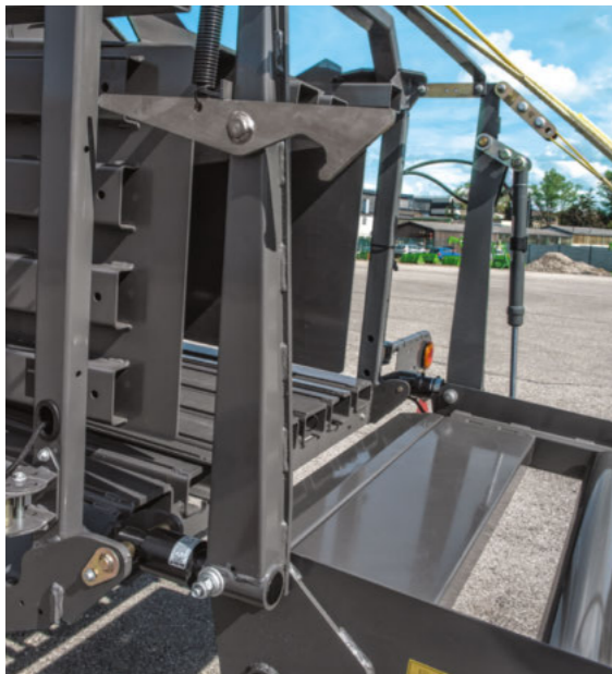
■ Vejcellerne mellem ballekammeret og ballestikken måler ballens nøjagtige vægt og sender dataene direkte til din terminal.
