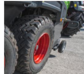
□ Det hydrauliske støtteben (ekstraudstyr) gør det nemt og hurtigt at til- og frakoble traktoren.
