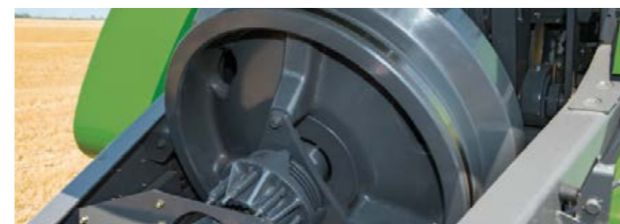
Svinghjulet på 545 kg giver mulighed for ensartet og jævnt forløb og sikrer stor kraftoverførsel.
