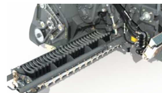
Den sænkede knivskuffe kan trækkes ud i venstre side af maskinen for udskiftning af knive.
