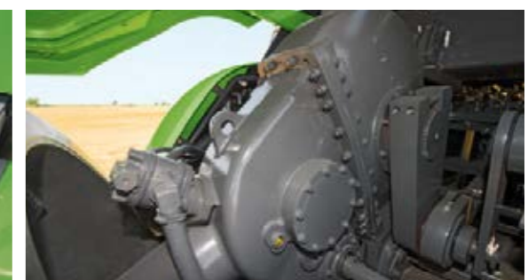
Der anvendes en ny gearkasse med stor kapacitet i XD ballepresseren. I alt er XD gearkassen 35 % tungere end standardmodellen og kan derfor generere endnu større kompressionstryk.
