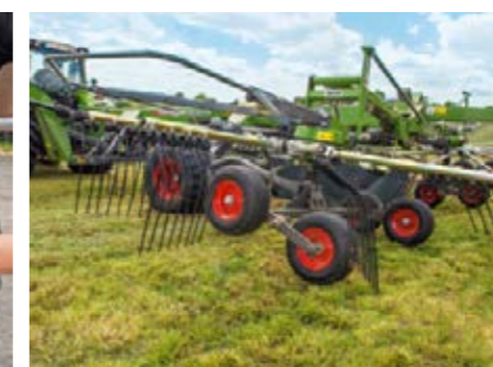
Ved sænkningen på forageren berører baghjulene først jorden, fulgt af forhjulene. Ved løft hæves forhjulene først. Denne Jet-Effect beskytter skåret.
