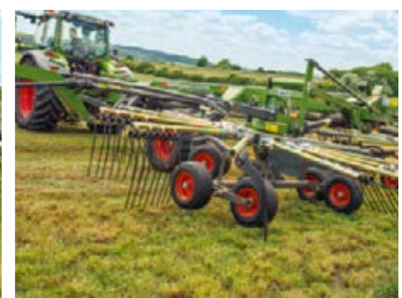
Ved sænkningen på forageren berører baghjulene først jorden, fulgt af forhjulene. Ved løft hæves forhjulene først. Denne Jet-Effect beskytter skåret.
